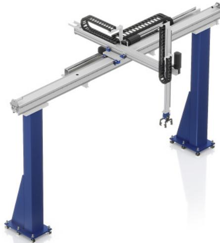
Der AGC-2 ist für Handhabungsgewichte bis 90 Kg ausgelegt, bewältigt Vertikalhub bis etwa 2,5 m und erreicht eine Verfahrensgeschwindigkeit bis 2 m/s bei einer Beschleunigung von bis zu 4 m/s<sup>2</sup>.
